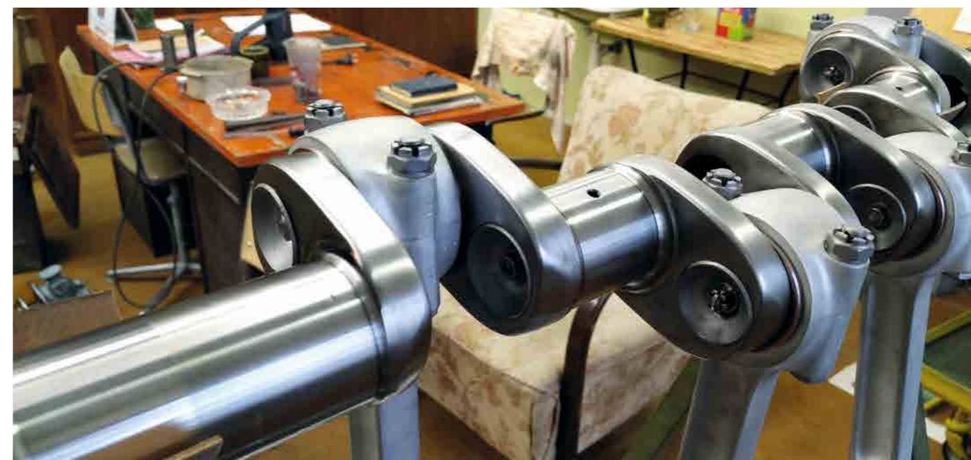
• Kliková hřídel po vyčištění.
