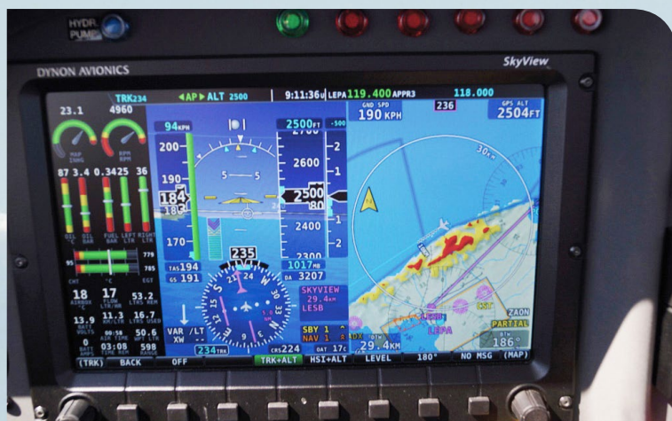
Primární obrazovka při letu kolem severního pobřeží Mallorky. Červené plošky na mapě v pravé třetině zobrazují terén, který je výše než letadlo nebo jen o 30 metrů níž a žluté označují cokoliv co je níže o 30-300 metrů než letadlo (tzn. varování).
