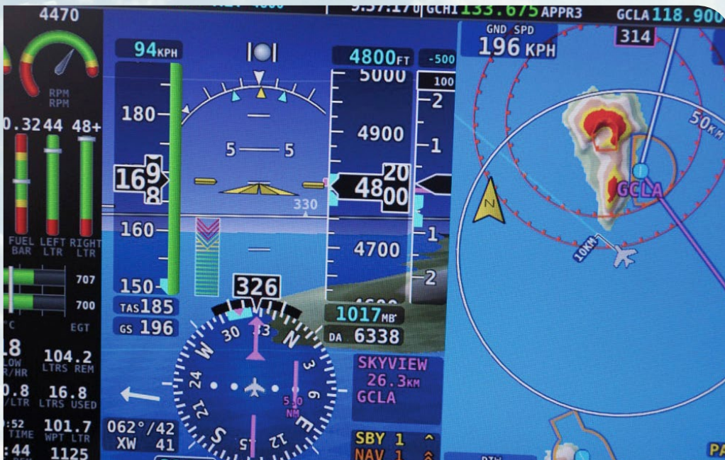
Přiblížování k ostrovu La Palma. Síla a směr bočního větru je vidět na údajích v levém dolním rohu prostřední třetiny obrazovky. XW 41 znamená boční složku větru o rychlosti 41 km/h. Za chvíli se zvýšila na 45 km/h a já jsem se dostal na závětrnou stranu La Palmy. V té chvíli jsem si jen stále více utahoval pásy, abych neprorazil hlavou kabinu v letadle zmítaném turbulencí rotoru vznikajícího za vysokým pohořím ostrova, kudy jsem se nesprávně rozhodl letět.
