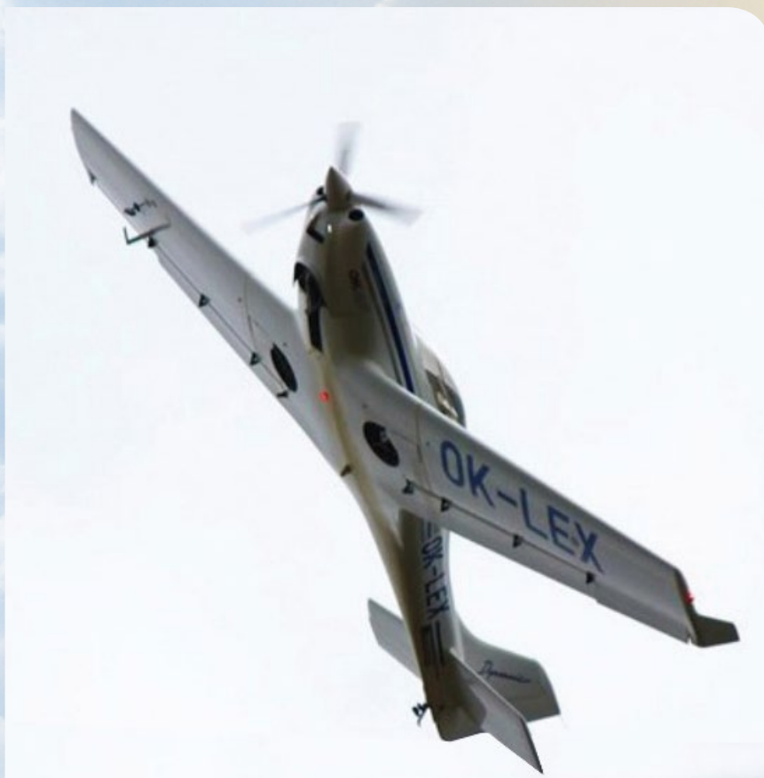
Letadlo Dynamic WT9 s imatrikulací OK-LEX. Zatahovací podvozek přispívá ke skvělé aerodynamice a tím vysoké rychlosti a nízké spotřebě paliva. Na snímku je na ostruže vidět držák s jednou z kamer.
