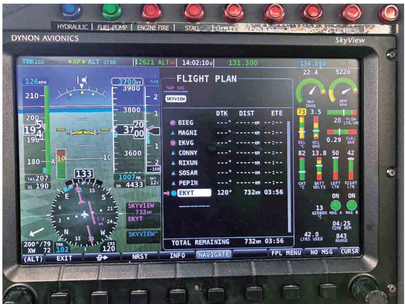
■ Jednotlivá stanoviště řízení letového provozu mi během této cesty měnila navigační body, ke kterým jsem měl směřovat. Nakonec jsem to řešil tak, že jsem z palubního počítače vymazal celý svůj letový plán mimo cílových letišť a jednotlivé navigační body jsem doplňoval až podle dispozic řízení letového provozu. Tady jsem už nějaké dvě hodiny letu od Vagaru a mám před sebou další 4 hodiny letu do asi 730 km vzdáleného Aalborgu
