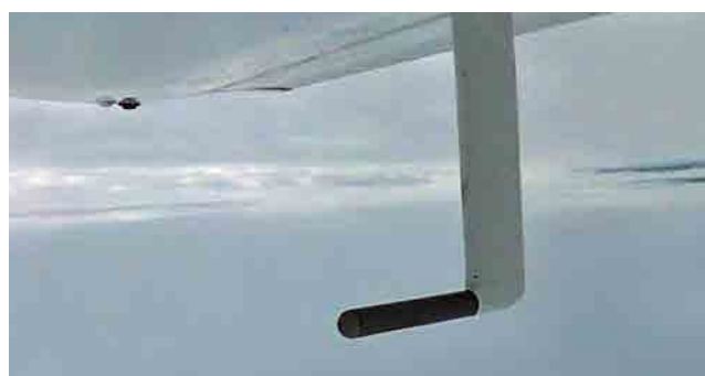
■ Tady je Pitotova trubice, která když zamrzne, tak přístroje ztratí informaci o rychlosti letadla. S ohledem na složité předpisy nemohu mít na OK LEX Pitotovu trubici s elektrickým vyhříváním, a tak se nesmím ztrátou informace o rychlosti prostě nechat rozhodit...
